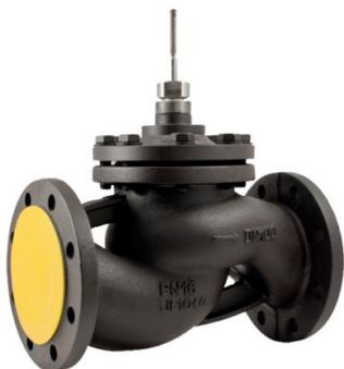
Данная новинка от торговой марки «АДЛ Торговый Дом» используется для регулирования расхода пара, жидкости или газов температурой до 200°C. Конструкция с разгруженным плунжером позволяет применять клапаны для перепадов давлений до 1,6 МПа. Также они оснащены мягким седловым уплотнением.
