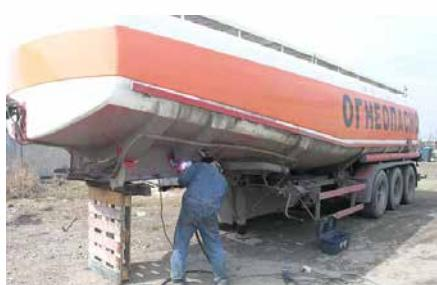
стерны и приступил к выполнению сварочных работ. От сварочной дуги пары нефтепродуктов в цистерне взорвались, в результате чего работник получил смертельные травмы.
