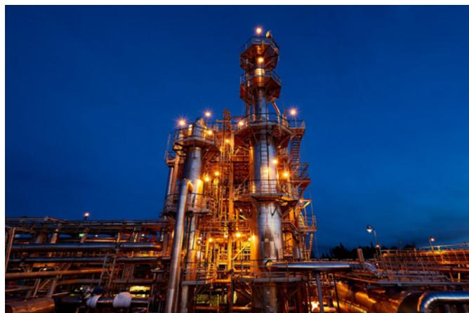
Работа новой установки глубокой очистки ШФЛУ идёт в непрерывном круглосуточном режиме. Мощность реализованной установки глубокой очистки ШФЛУ составляет до 1500 тыс. тонн в год.
