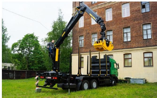
Новая модель получила цепной привод второго удлинителя, а гидравлические линии убраны внутрь коробов, что позволило уменьшить конструкцию узла, а также увеличить и защиту от повреждений РВД с трубопроводами, а также упростить замену изношенных рукавов в полевых условиях.
