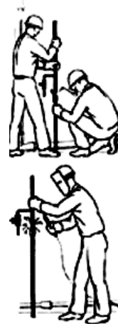
Рис. 14. Прокладка трубопроводов внутреннего водопровода на сварке
