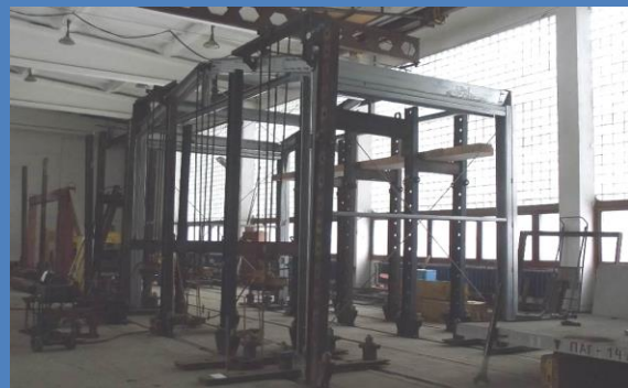
Каркас. Максимальная нагрузка: 160% расчетной.
