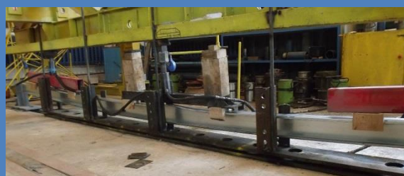
Стеновой прогон. Максимальная нагрузка: 196 - 256% расчетной
