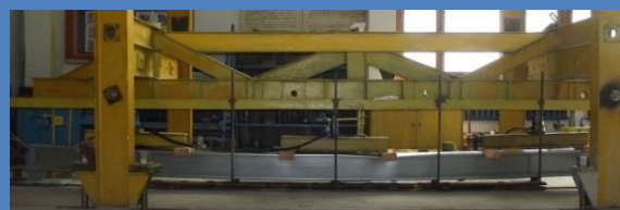
Кровельный прогон. Максимальная нагрузка: 136 - 146 % расчетной
