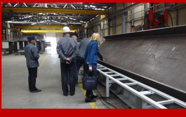
Кровельный прогон. Максимальная нагрузка: 136 - 146 % расчетной
