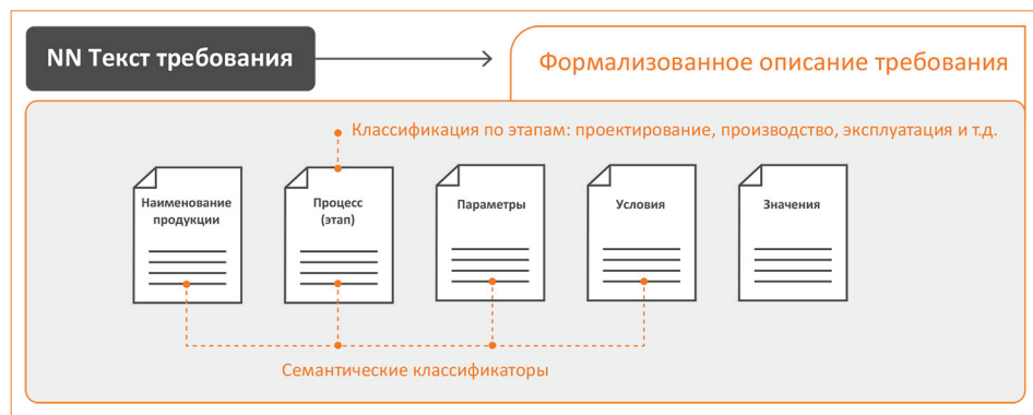
Рис. 2. Схема формализованного изложения требований на машинопонимаемом языке
