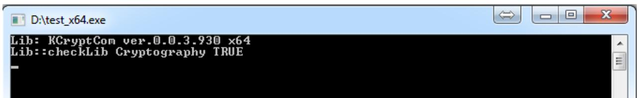
Рисунок 29.1. Проверка установки криптокомпонента KCryptCom.
